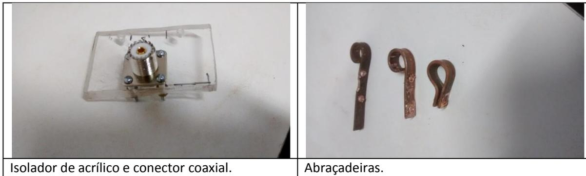
Foram confeccionadas duas abraçadeiras para serem fixadas na chapa de acrílico de modo a abraçarmos dois tubos de cobre. nos tubos. Os dois terminais do conector coaxial foram ligados a estas abraçadeiras com fio de cobre.
